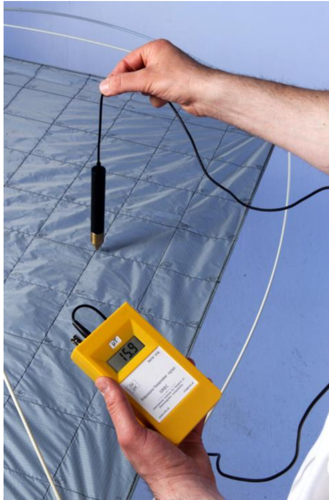
Abb. 9: Messaufbau für eine FKM-Messung
